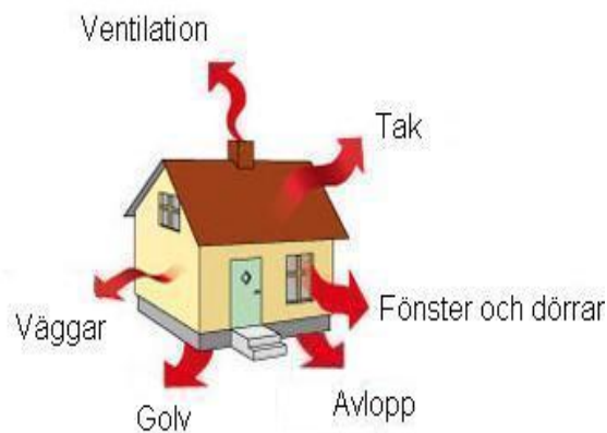
Figur 1. Illustration av värmeförlusterna i en byggnad. Modifierad bild från energimyndighetens hemsida 2009.
